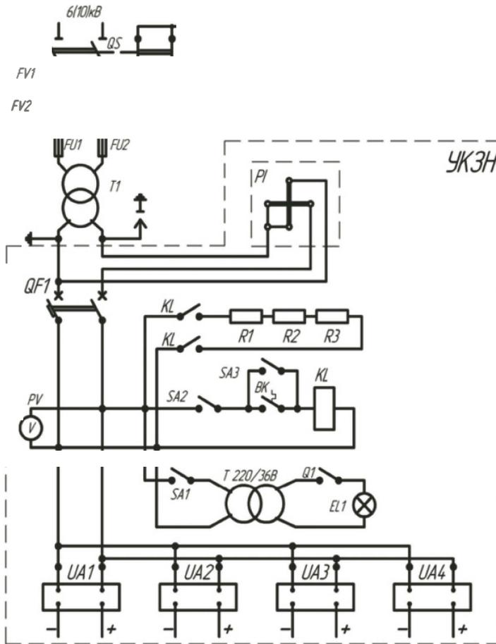
СХЕМА ЭЛЕКТРИЧЕСКАЯ ПРИНЦИПИАЛЬНАЯ УКЗН
